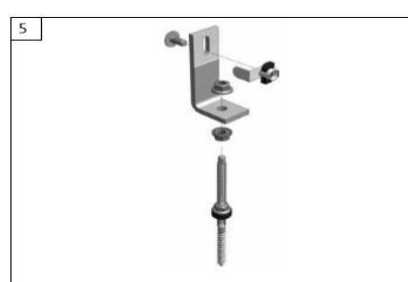
Śruba mocująca z gwintem podwójnym
